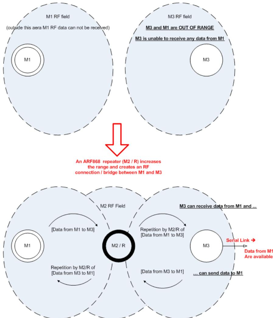
Le principe de fonctionnement du mode répéteur repose sur l'écoute du canal radio pour lequel le produit a été programmé et la retransmission des trames RF reçues sur ce même canal. La répétition est donc temporelle. Ainsi, une trame reçue par un produit répéteur est réémise après un temps de garde paramétrable et une scrutation du canal radio avant émission (mécanisme de LBT : Listen Before Talk)\*.
