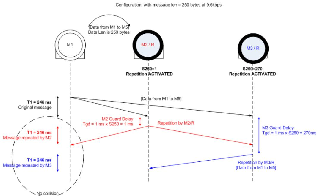
Éléments de calcul des temps de propagation RF d'une trame :
